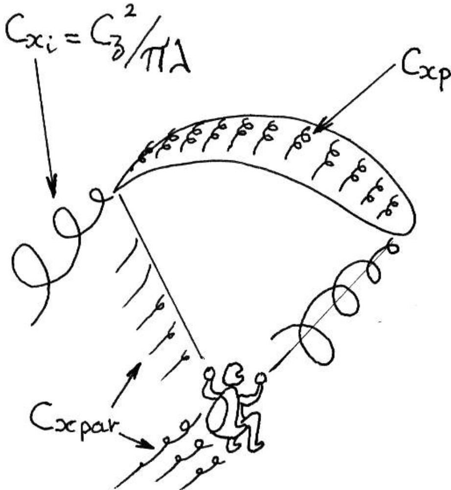
$$C_x = C_{x_{induit}} + C_{x_{profil}} + C_{x_{parasite}}, \text{ avec}$$
